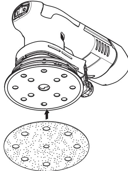
**!** Si l'adhérence du revêtement StickFix diminue, il est possible que des accessoires du patin de ponçage se détachent du patin de ponçage,
