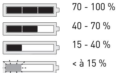
**Recommandation :** recharger le bloc batteries avant de continuer de l'utiliser.
