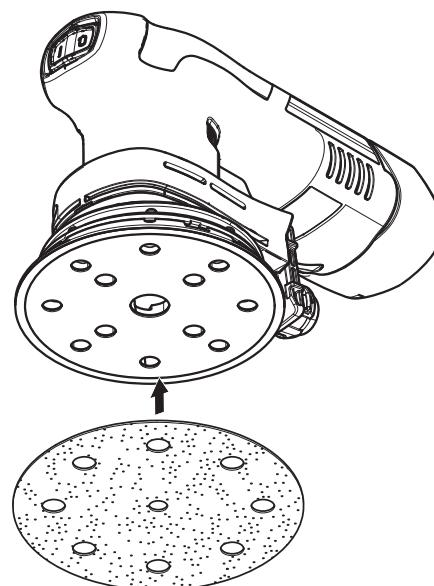
**!** En la medida que disminuye la adherencia de la capa StickFix, los accesorios de plato lijador (en especial en funcionamiento no acoplado) **pueden soltarse del plato lijador y provocar lesiones.** Cambiar el plato lijador.
